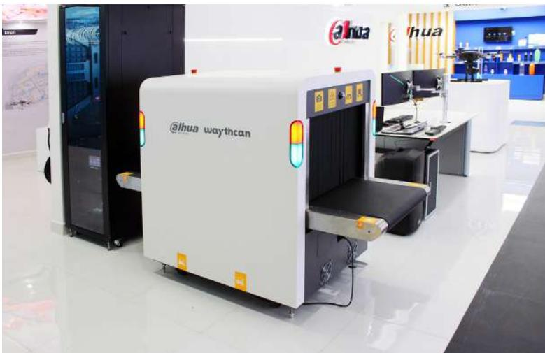
El túnel cuenta con cortinas de recubrimiento de plomo para evitar la exposición a la radiación, aun así, la ISC-M6550 cuenta con una protección de seguridad mayor al recomendado por el estándar internacional. Cuenta con ventilación para evitar sobrecalentamiento, sistema de ahorro de energía y botón de paro de emergencia.
